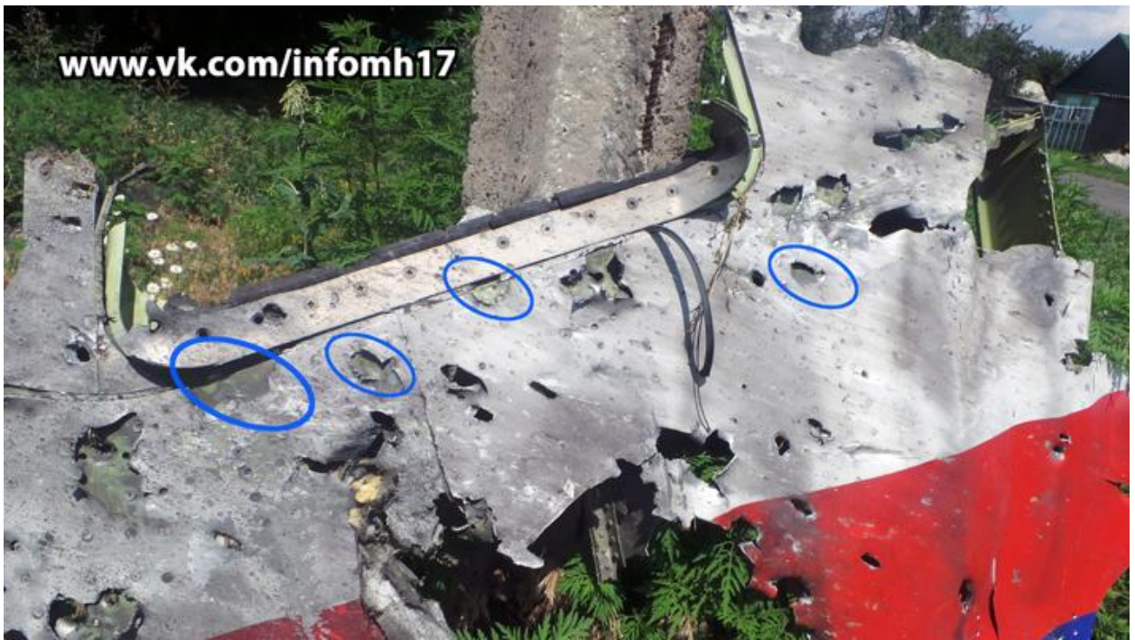
Глухие отверстия с внешней стороны кабины (сколы).
